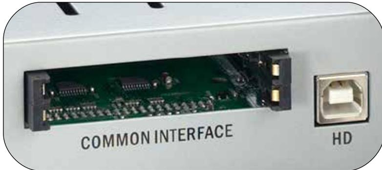
An der Frontseite des Gerätes finden sich zwei Einschübe, die zur Aufnahme von Modulen zur Dekodierung verschlüsselter Programme vorgesehen sind. Um eine Beschädigung zu vermeiden, dürfen ausschließlich Module gesteckt werden, die das „PC Card“-Logo tragen. Andere Module können irreparable Schäden am Receiver verursachen.
